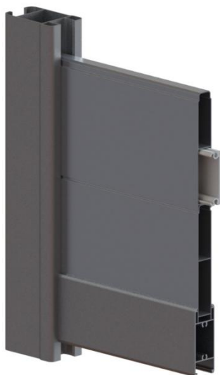
Reforço em lâmina tapada de 150 x 25 Perfil de alumínio de 72 x 22 mm
