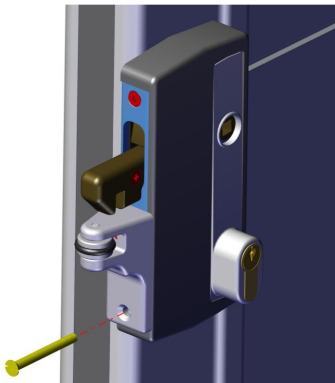
Aperte o cilindro com o parafuso de cabeça chata em inox M5x70.
