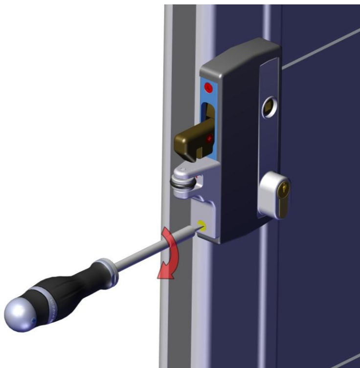
Aperte o cilindro com o parafuso de cabeça chata em inox M5x70.
